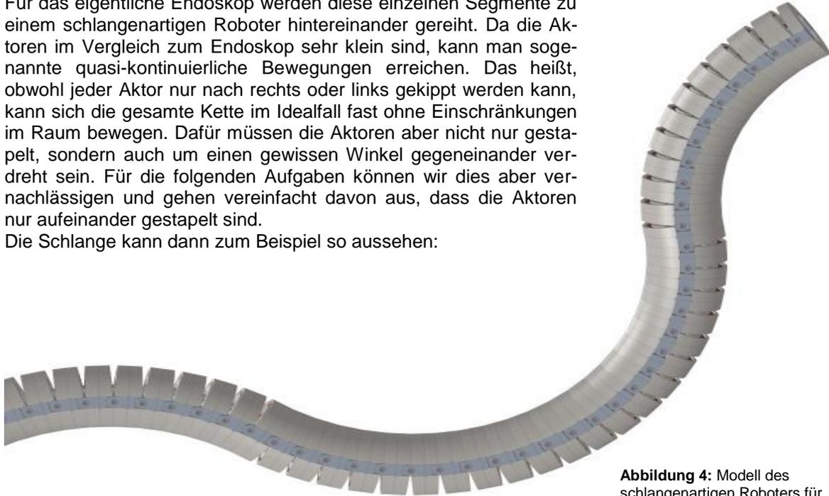
Abbildung 4: Modell des schlangenartigen Roboters für die Endoskopie
