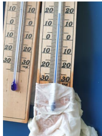
Bild rechts: Das feuchte Papiertuch muss dünn um das Thermometer gewickelt werden
